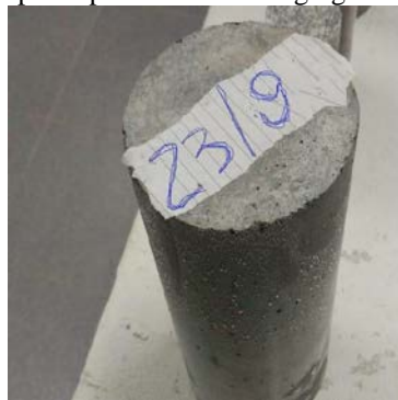
Figura 2: Corpo de prova feito com agregado miúdo (pneu)
