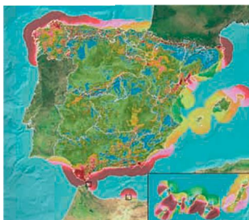
Figura 16: Densidad de potencia del viento a 60 m-Fuente: IDAE
