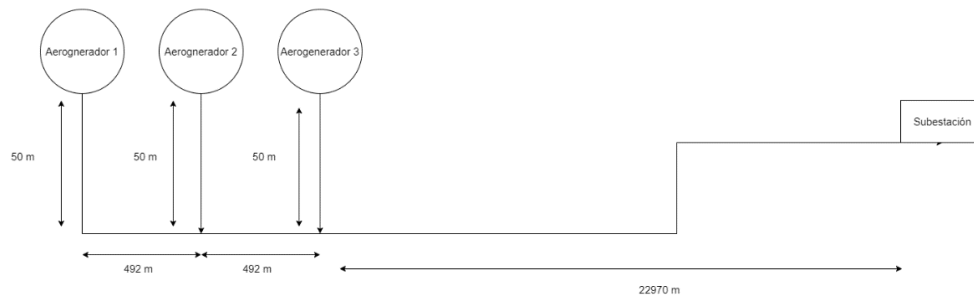
Figura 74: Disposición de cableado- Fuente: Elaboración propia
