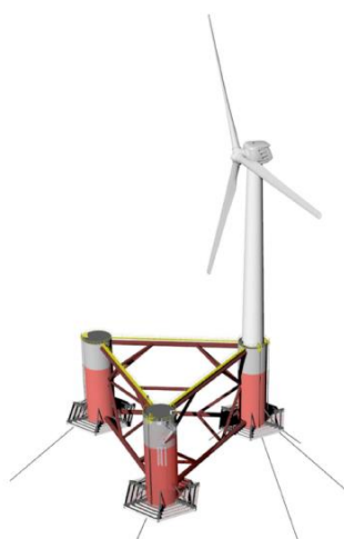
Figura 59: Representación en 3D plataforma Windfloat-Fuente: PrinciplePower
