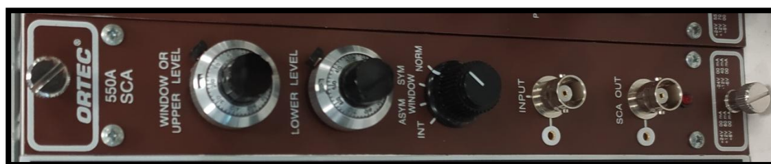
Figura 49: Analizador mono-canal (SCA) Ortec 550A. Fuente: Propia
