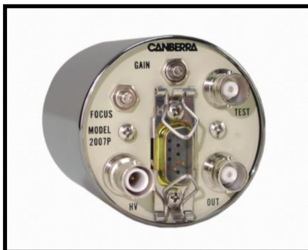
Figura 46: Preamplificador Canberra 2007P. [25]
