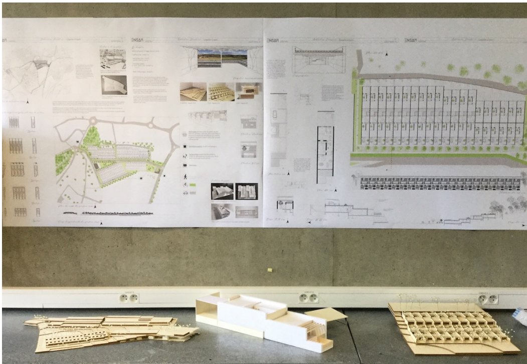
Fig. 3: todas las escalas entre el edificio y lo urbano quedan tratadas de forma entrelazada al final del curso; la manzana se trata en la maqueta y dibujos a la derecha, y la unidad tipológica, con sus problemas constructivos, en el centro (Proyecto: Marie Laurent. Fuente: los autores)
