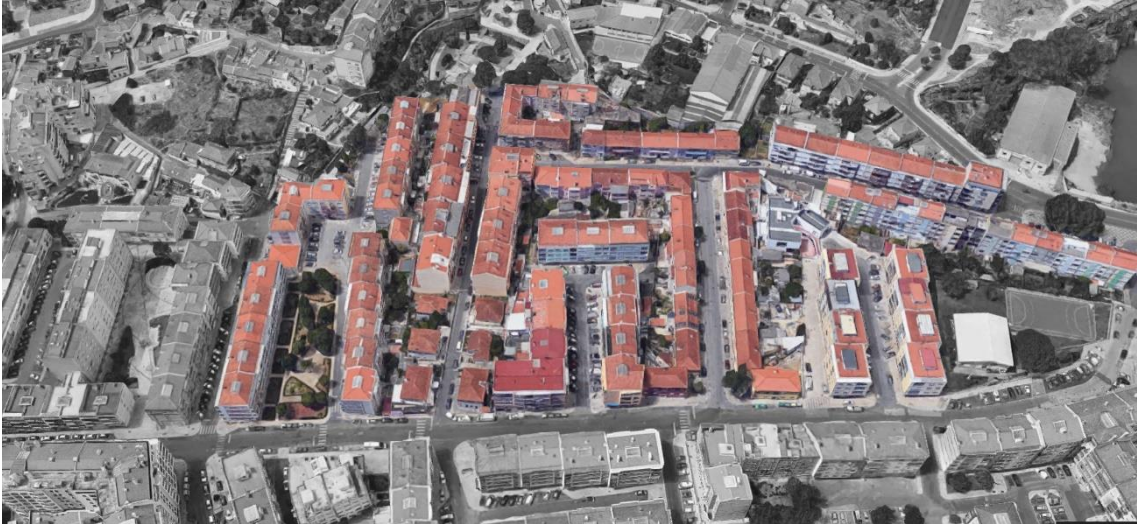
Fig. 20 Ejemplo de tipo de tejido urbano basado en la agregación de bandas y formando pequeños conjuntos o bloques abiertos resultante de procesos incrementales de urbanización (Agualva). Fuente: adaptado de Google Maps
