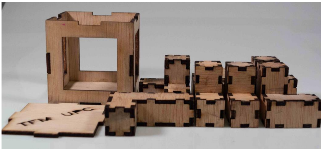
Fig. 28 - Cub Soma fabricació talladora làser (recurs propi)
