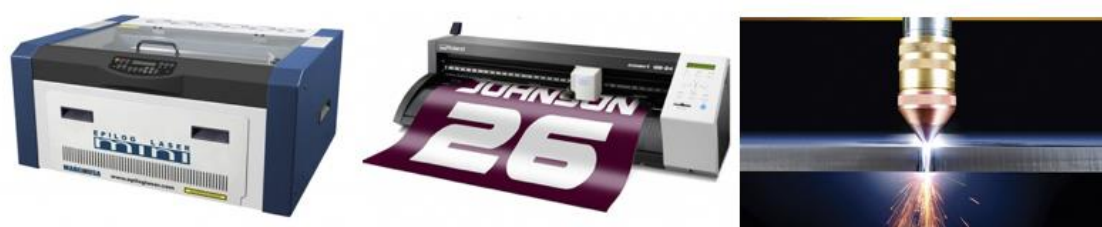
Fig. 14 - Màquines de Tall CNC – Esquerra, Talladora Làser (Epilog Laser, no date)– Centre, Talladora de Vinil (Roland, no date)– Dreta, Capçal talladora de plasma (Tiffor; no date)
