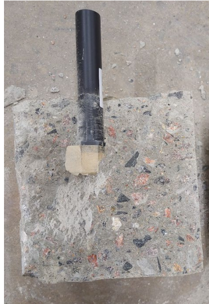
Figur 3.7 Halverad betongkub med fuktsensor från Electrotech.
