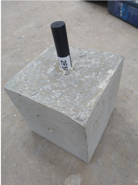
Figur 3.6 Betongkub med vct 0,4 med ingjuten fuktsensor från Electrotech.
