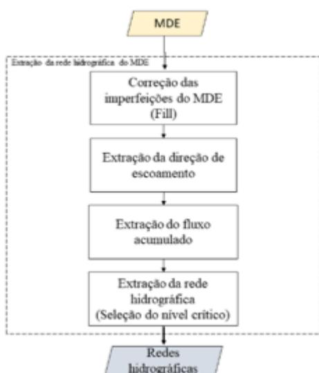
Fig. 2 – Fluxograma com os processos de extração das redes hidrográficas.
