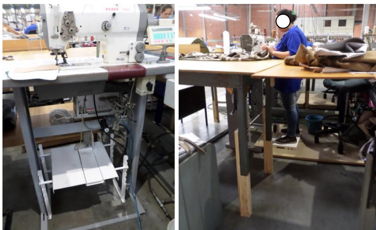
Figuras 10 e 11 – Máquina com regulagem de altura e altura do plano de trabalho
