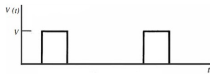
Figura 13 – Representação gráfica de pulsos de onda quadrada. Fonte: Knoll [4].
