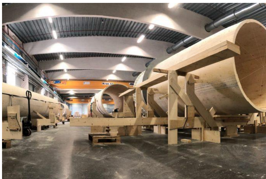
Figura 9 – Torre de Aerogerador em Madeira
