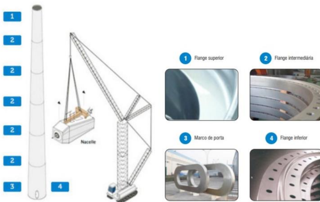
Figura 5 – Estrutura das Torres Eólicas de Aço Cônicas
