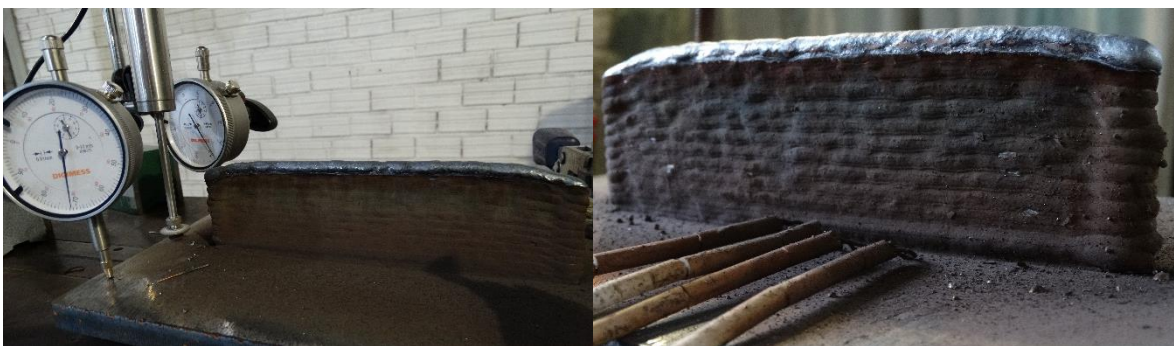
Figura 46 – AWS ER110S-G. (a) Figura ilustrativa dos relógios comparadores no metal base após a deposição dos cordões. (b) 25 cordões depositados o modo pulsado sinérgico com indicação dos termopares no metal base.
