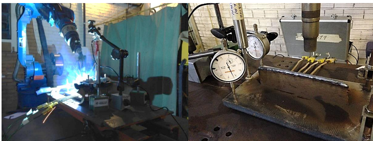
Figura 54 – Deposição dos cordões com o eletrodo AWS ER110S-G. Aparato experimental para aquisição de temperatura e deformação.
