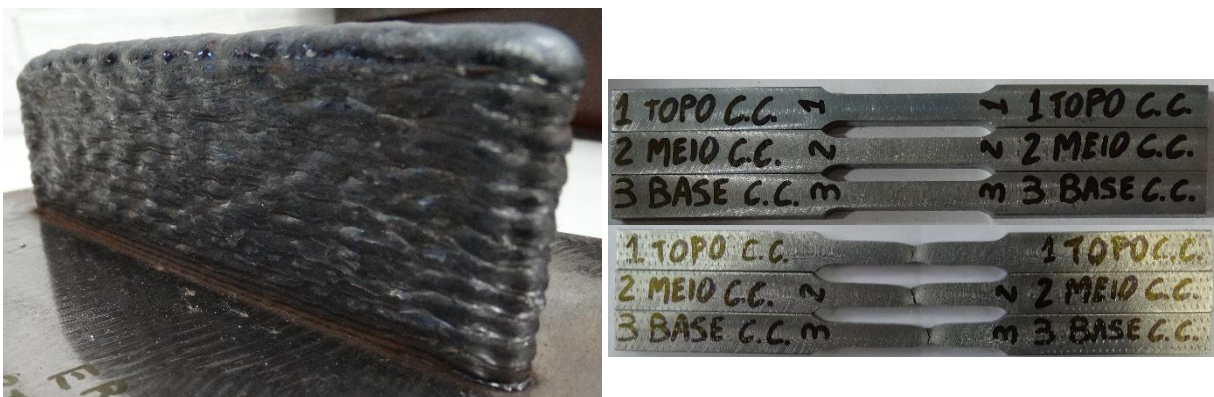
Figura 49 – Sinérgico G6. AWS ER110S-G. (a) 25 cordões depositados. (b) Corpos de prova para ensaio de tração antes e depois do teste, separados em topo, meio e base.
