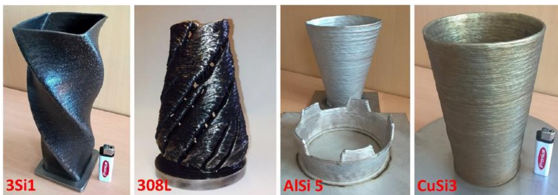
Figura 6 - Exemplos de objetos produzidos por CMT. Da esquerda para direita em aço sem liga, aço inoxidável, alumínio e cobre. [Posch et al., 2017].
