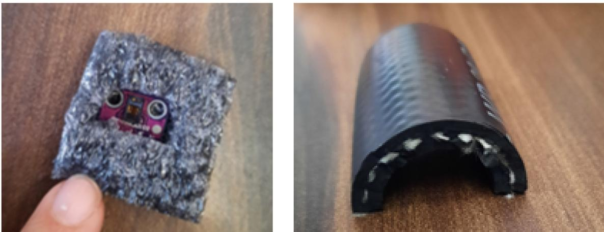
Quanto à parte elétrica, para evitar mau contato soldou-se os fios de conexão na placa do arduino e no chip. Como o sinal proveniente o MAX30102 já é condicionado e digital, não há grandes problemas na recepção do mesmo.
