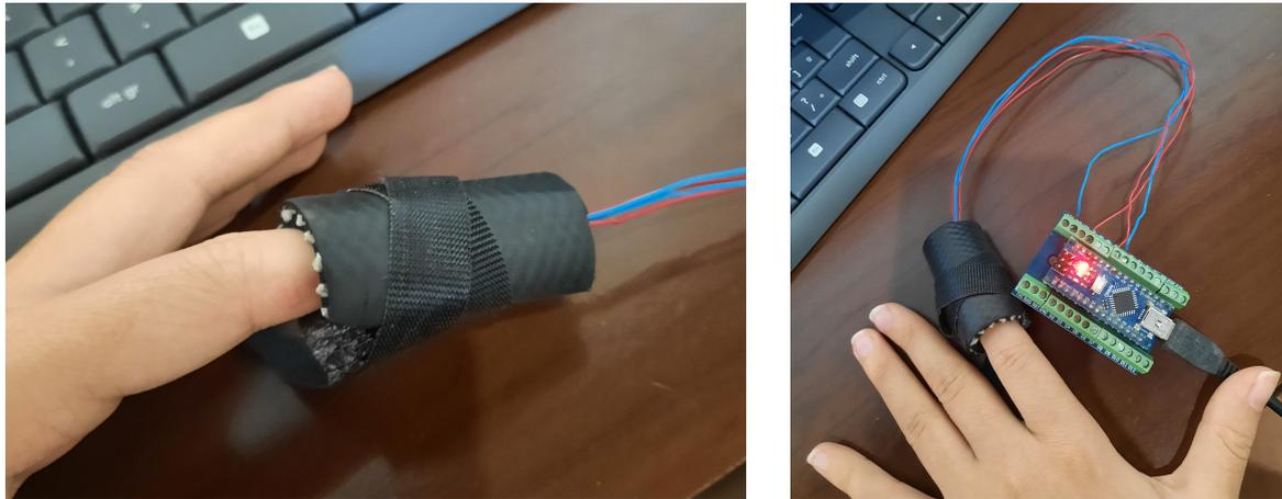
Figura 39 – Espuma e mangueira utilizadas para acondicionamento do sensor
