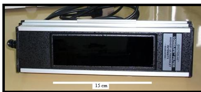
Figura 17. Lámpara UV de mano utilizada en las irradiaciones ( \lambda=254 ).
