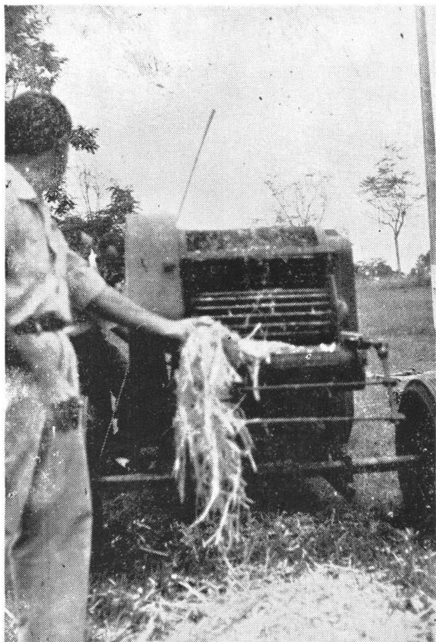
Material decorticado sendo retirado da máquina. Podendo-se notar ainda os pedaços do lenho restituídos ao solo, que podem atuar como fertilizante.
