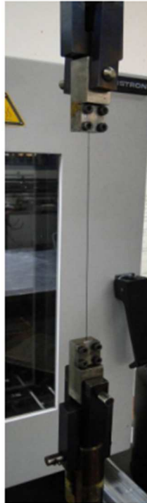
Figura 3.6. Sistema de mordazas de apriete montado en la máquina de ensayos Instron 5567.
