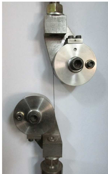
Figura A.5. Sistema de mordazas de cilindro diseñado y construido.
