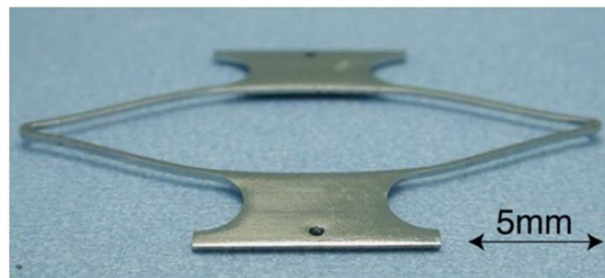
Figura 2.14. Probeta de NiTi con forma de diamante fabricada a partir de un micro-tubo por mecanizado láser [45].
