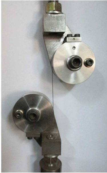
Figura 3.7. Sistema de mordazas de cilindro.
