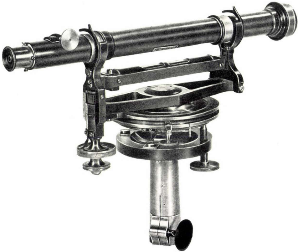
3. Stampfer-csavaros szintezőműszer, 1846. Gyártó: Nuss Antal. Az Országos Műszaki Múzeum tulajdona, 68.85.1. gy. sz.
