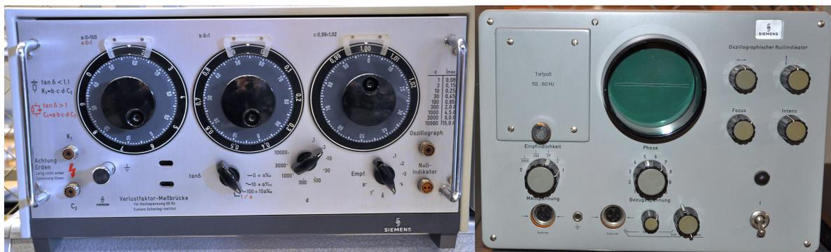
Abbildung 3.13: Vorderansicht der Schering-Messbrücke (l.) mit Nullindikator (r.) beim Versuchsaufbau
