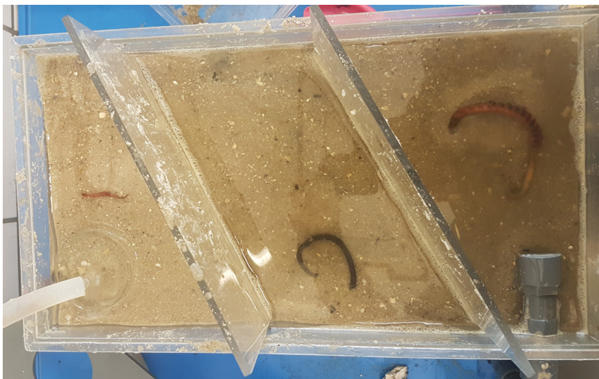
Abb. 1. Versuchsaufbau zur gesonderten Haltung von Wattwürmern im Labor (>30 cm tiefes Becken mit Zu- und Abfluss und zwei Plexiglasscheiben, welche Wasser durchlassen, aber das Becken effektiv in drei Habitattteile aufteilen)
