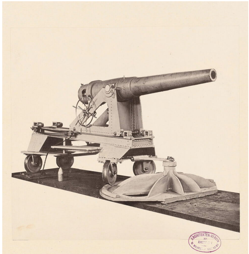
Gussstahlfabrik Friedrich Krupp, Essen (1871): Ansicht lange 15 cm Kanone in hoher Küsten-Laffete © Architekturmuseum TU Berlin
