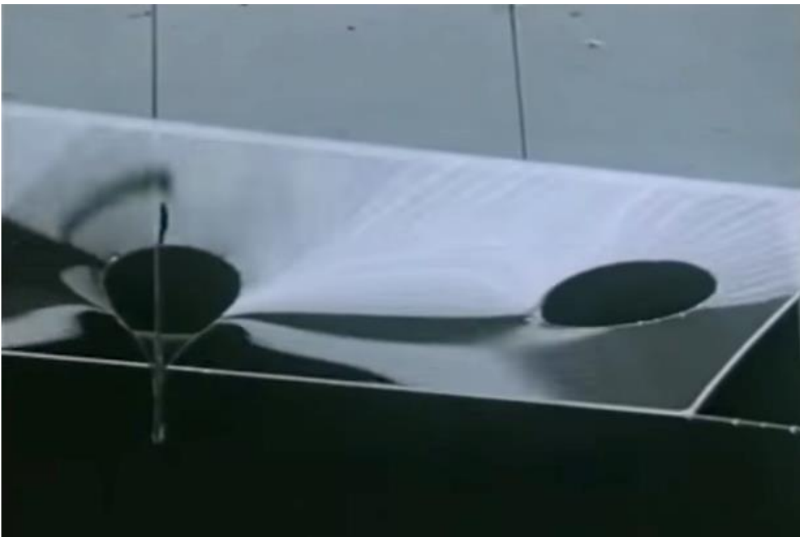
Imagen 56: Maqueta de pequeñas dimensiones sobre una película de jabón
