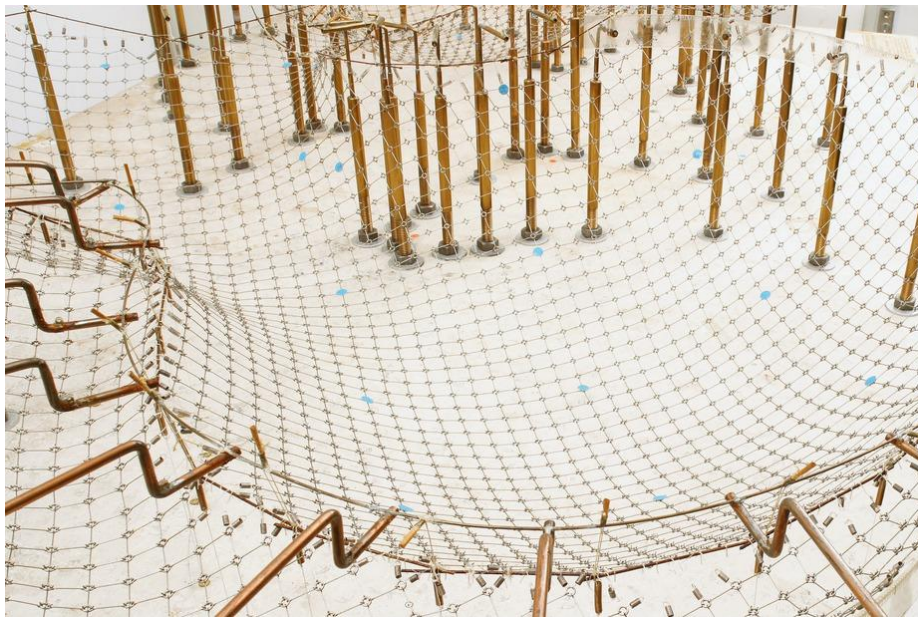
Imagen 148: Maqueta colgante tridimensional. Foto de Uwe Dettmar
