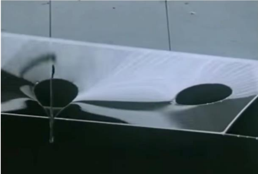
Imagen 63: "Modelo de diseño de pequeñas dimensiones" de una película de jabón modificada. IL 1961
