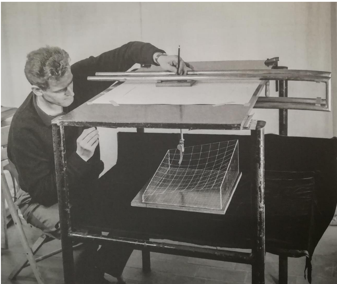
Imagen 92: Instrumento creado en el IL para obtener las coordenadas de los puntos de una superficie compleja.
