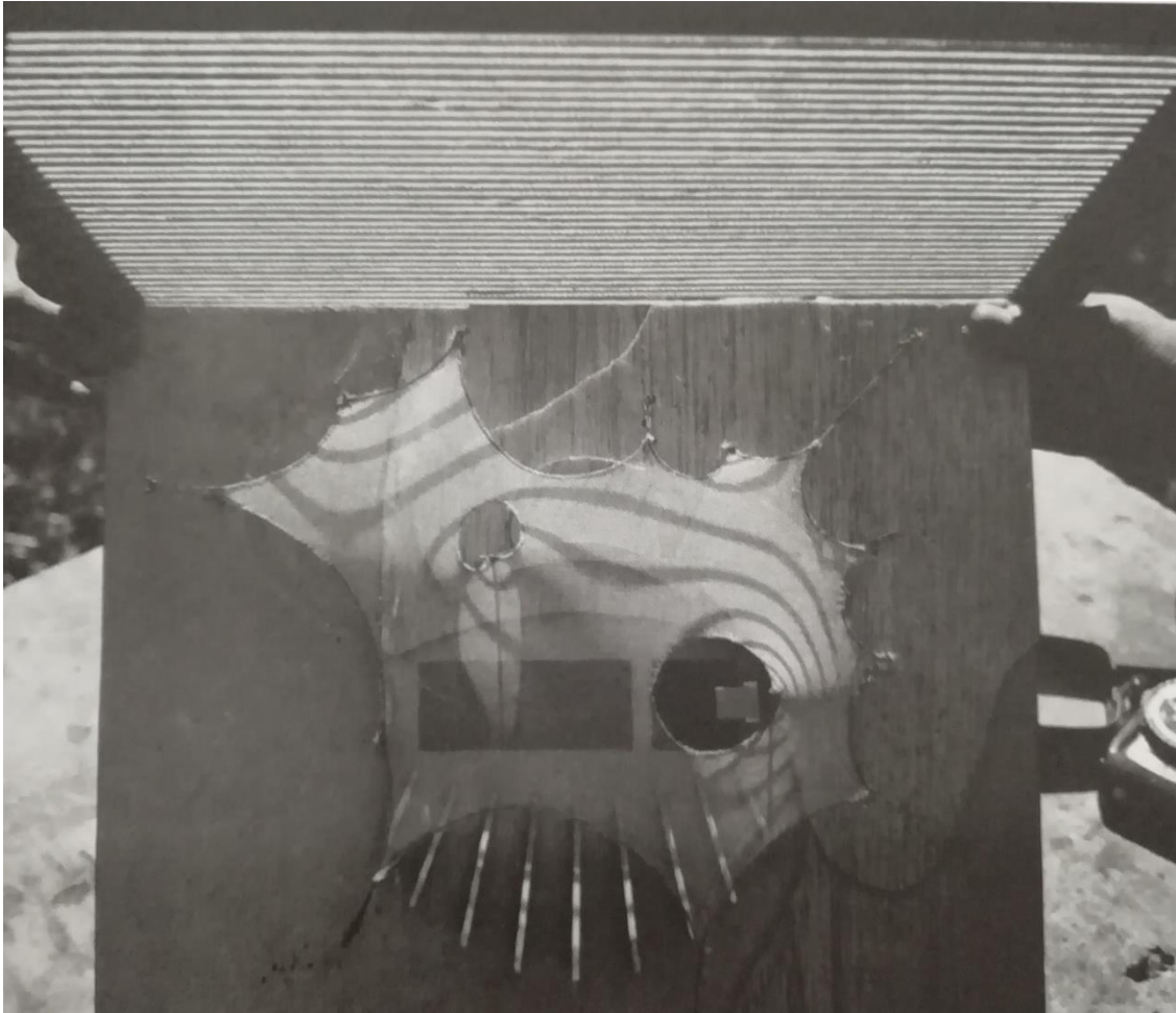
Imagen 69: Modelo construido con tela para reflejar líneas de luz horizontales con el objetivo de representar las curvas de nivel de tan compleja superficie.
