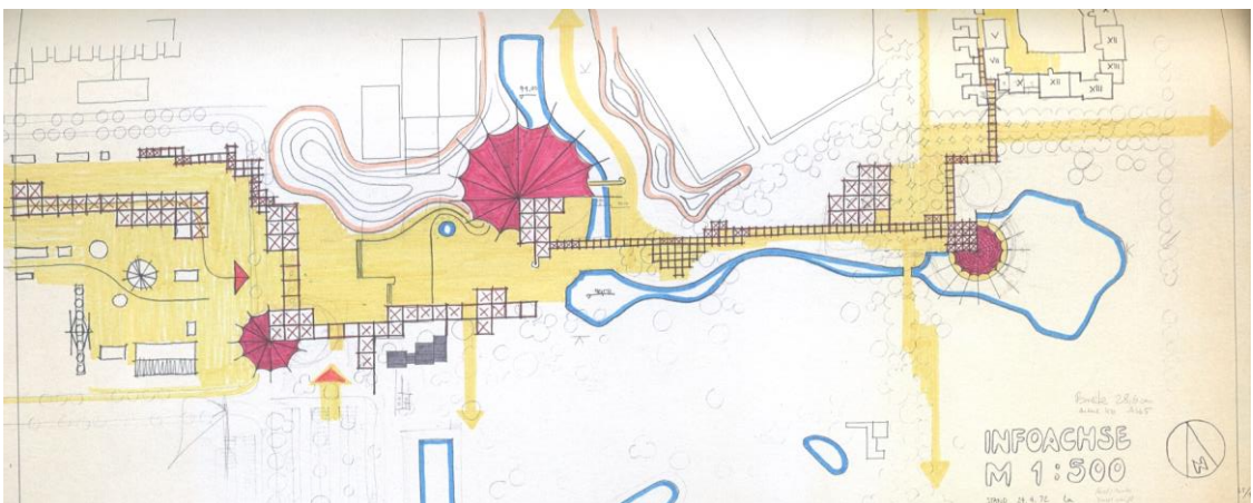
Imagen 154: Propuesta anterior a la final. El Pabellón temporal iba a estar cubierto por una membrana tensada con cables.
