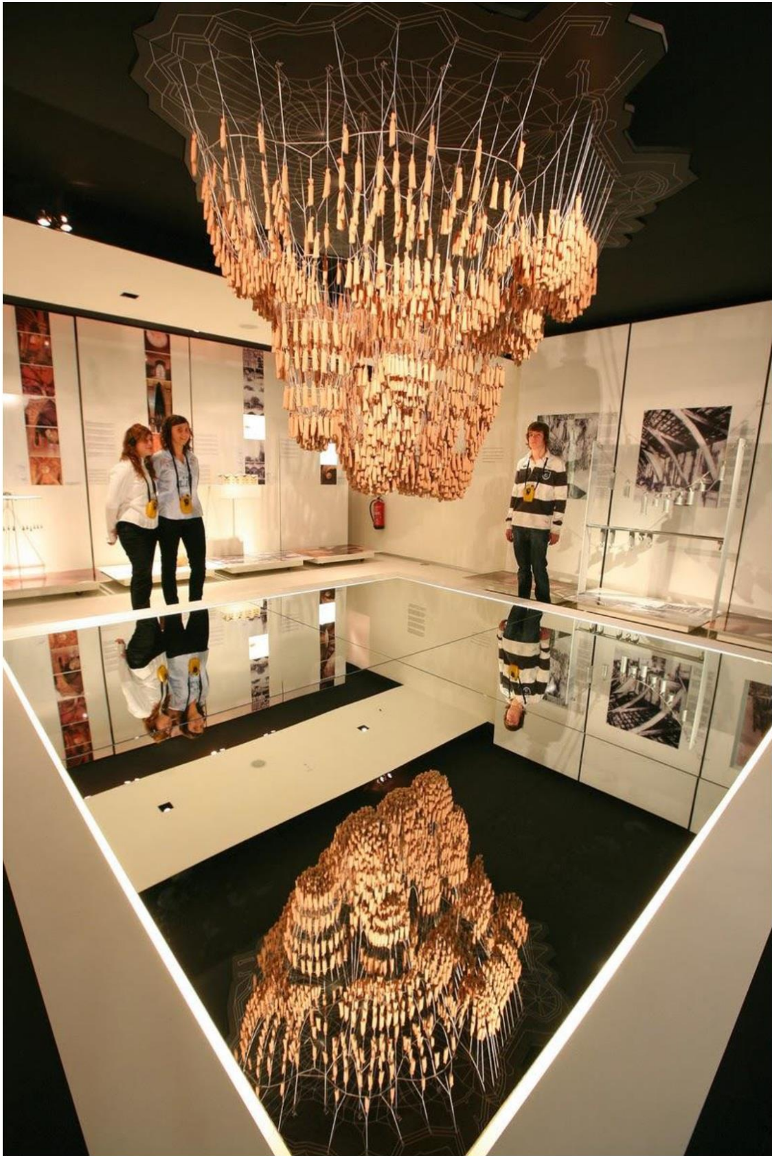
Imagen 7: Maqueta funicular de la Sagrada Familia. Gracias al reflejo del espejo tenemos el resultado de lo que sería una estructura que, manteniendo una orientación vertical, resulta apta para la construcción.
