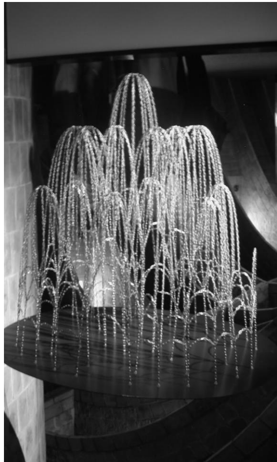
Imagen 5: Modelo físico estructural de Gaudí para la Iglesia de la Colonia Güell
