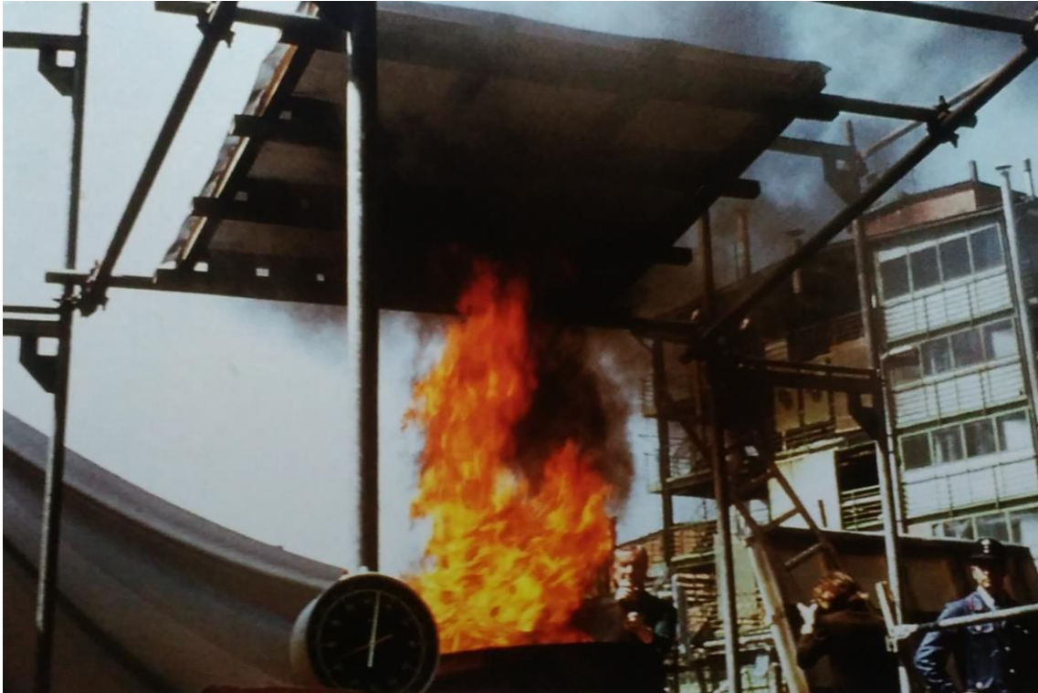
Imagen 172: Prueba de fuego en un panel de la celosía de madera impregnada de solución ignífuga y revestimiento de membrana. Fuente: Institute for Lightweight and Conceptual Design (ILEK), Universidad de Stuttgart.
