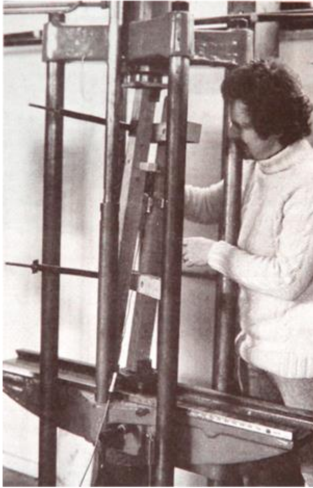
Imagen 170: Prueba de rigidez a cortante.
