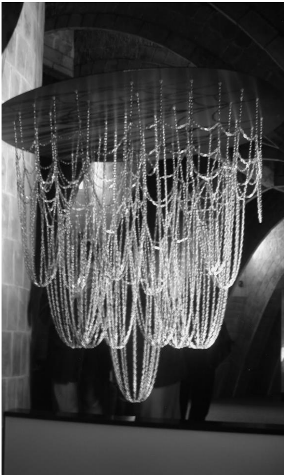
Imagen 6: Maqueta con cadena de la Iglesia de la Colonia Güell
