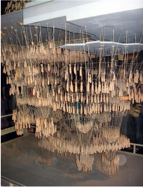
Imagen 5: Modelo físico estructural de Gaudí para la Iglesia de la Colonia Güell
