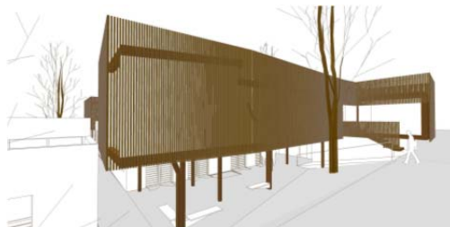
Fotografía 33. Reforma Colegio Les Carolines, Picasset. Madera acetilada
