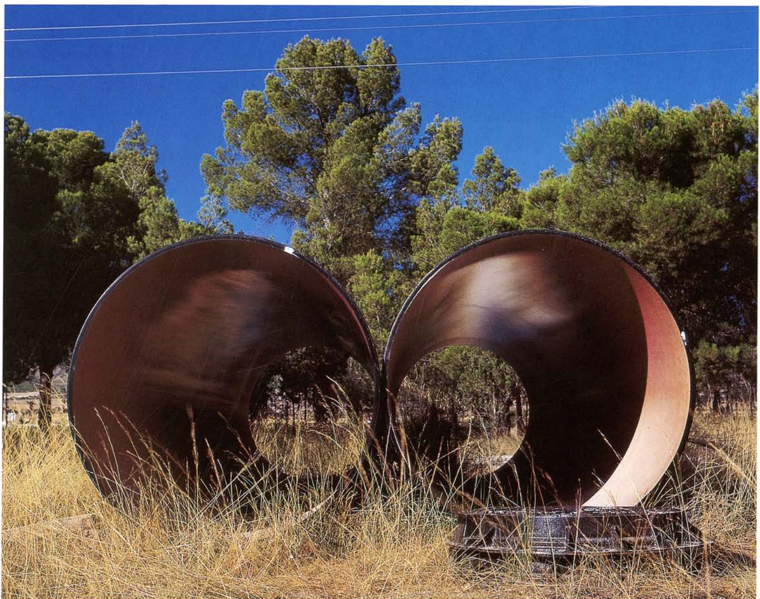
Tuberías de poliéster reforzado con fibra de vidrio (foto F. Albert y E. Ortiz).
