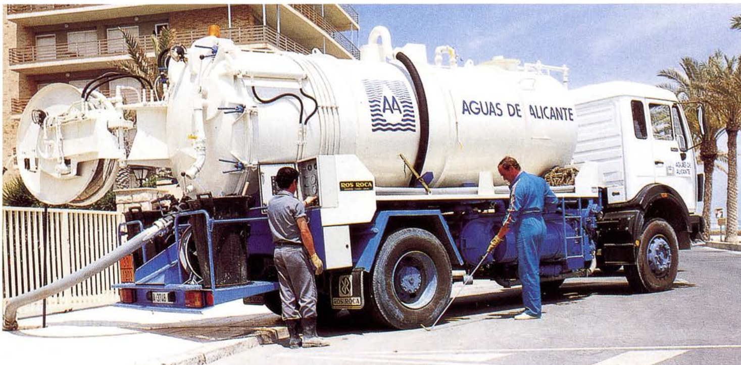
Unidad de mantenimiento de alcantarillado.
