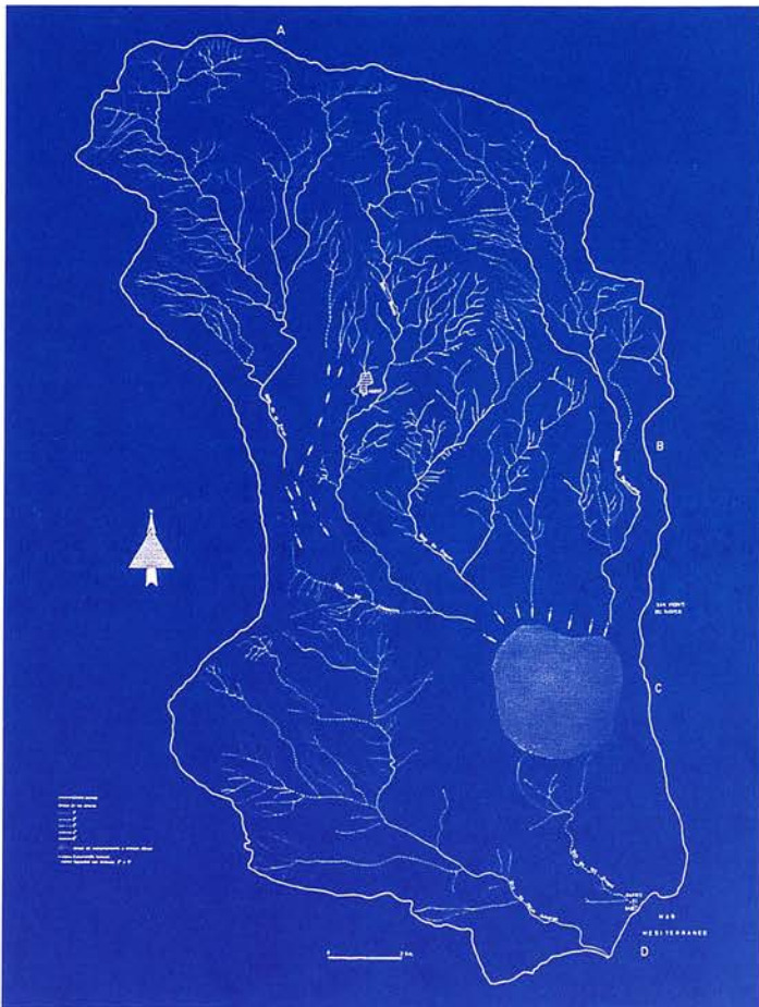
Esquema de la red de Colectores que integran la Cuenca del "Barranco de las Ovejas". Desde las estribaciones del Maigmo hasta el desagüe en el Barrio de Babel, una red dendrítica recorre las vertientes desnudas y normalmente secas.
