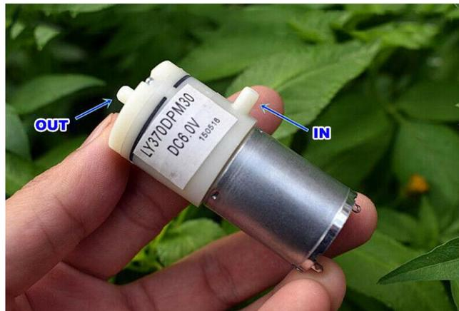
Ilustración 16: Bomba de vacío.
