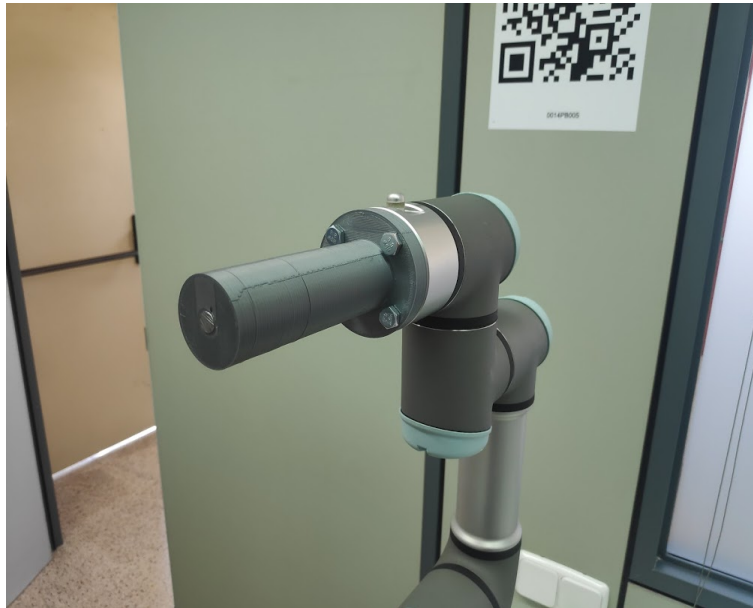
Figura 18: Unión final con el robot. Fuente: elaboración propia
