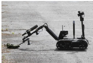
(a) Robot EOD para la desactivación de artefactos explosivos. ( Atria Innovation , 2020)
