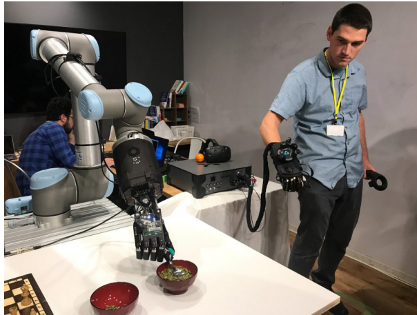
Figura 2.3: Una de las primeras interfaces de teleoperación háptica, diseñada por Shadow Robot ( haptx.com , s.f.).
