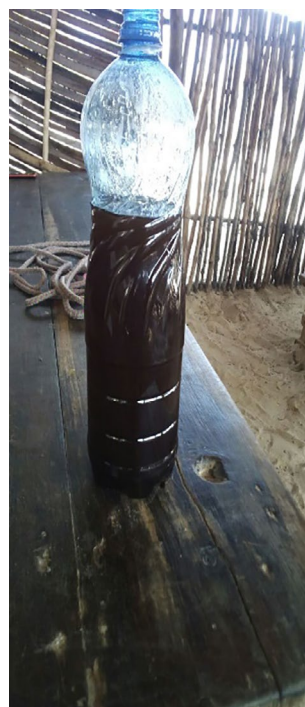
Figura 2. Sistema de medida del consumo de aceite en la elaboración del chapati .
