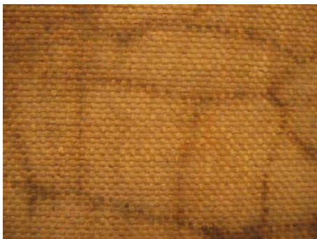
d - Detall del teixit de la tela amb tafetà i fils dobles.
