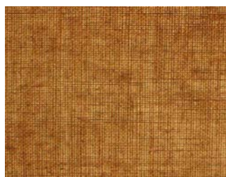
Fig. 3. Detall de teixit de tafetà.
