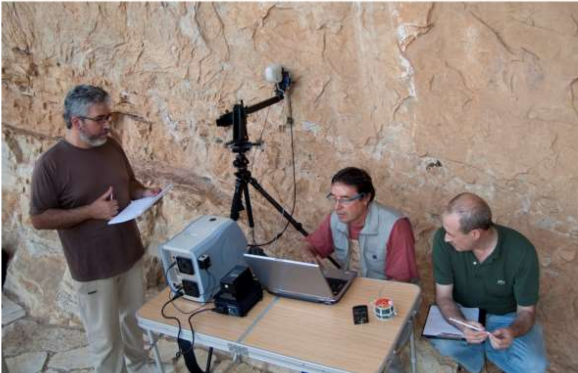
Figura 3 Utilización de la espectroscopia micro-Raman portátil sobre pinturas de la Cova dels Rossegadors o Polvorín. Fuente: R. Viñas et alii. (2015)
