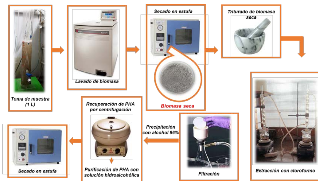
Figura 2.8: Esquema de la metodología para extracción y purificación de PHA
