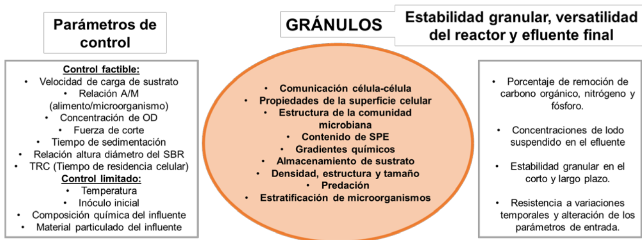
Figura 1.13 Ilustración esquemática de los diversos parámetros del proceso que afectan la formación de gránulos, el funcionamiento del reactor y calidad del efluente final.
