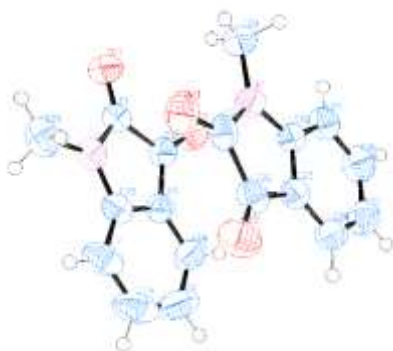
Figura 4. Gráfico de la estructura molecular de NMI obtenida mediante difracción de Rayos X mostrando el desplazamiento elipsoidal de los átomos diferentes de H al nivel de probabilidad del 40%.
