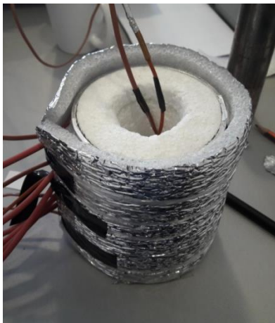
Figura 4 – Foto de ensayo con nitrógeno líquido.
