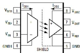
**Fig. 4.** Esquemático de Agilent HPCL7520
