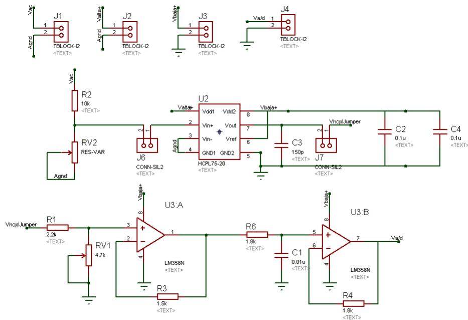
Fig. 7. Esquemático del circuito adquirente de datos
