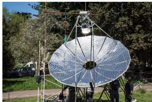
Figura 3. Prototipo de concentrador óptico con motor Stirling, área colectora 12 m 2 - 5 Kw. UNLP-CIC
