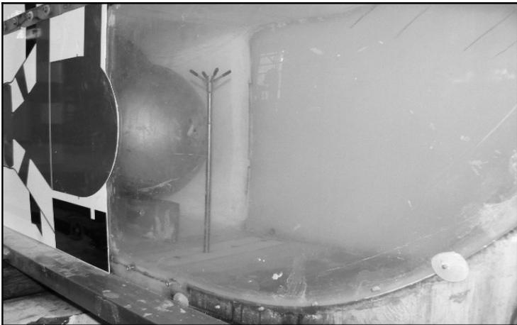
**Figura 12:** Medición de un punto con el ADV.
