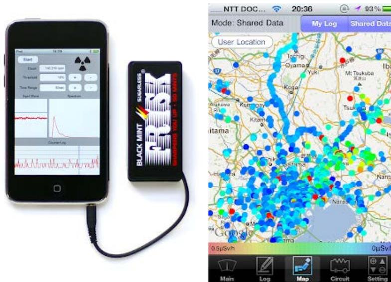
**Fig 23.** Radio-watch, aplicación de sensado participativo para recopilar datos de radiación ambiental.
