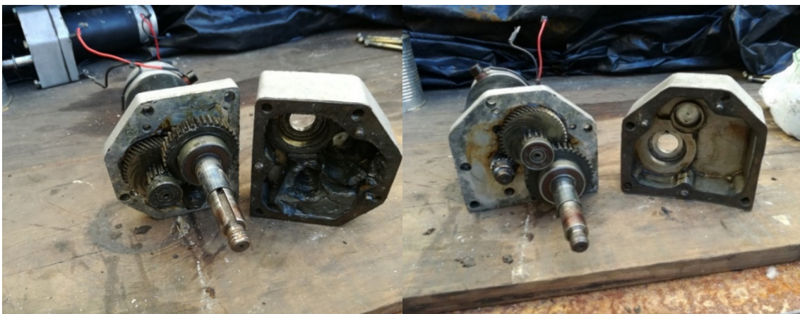
Figura 9. Apertura de carcasa. Remoción de grasa envejecida y limpieza. Fuente: propia
