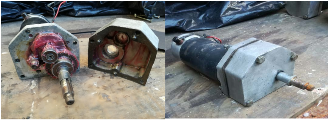
Figura 10. Lubricación con grasa de litio y ensamblado del motor Fuente: elaboración propia
