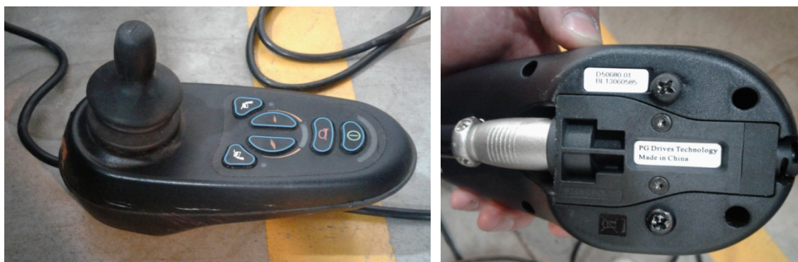
Figura 4. Joystick Dailymoving S-drive, 24 V, 90 A, programable. Fuente: elaboración propia
