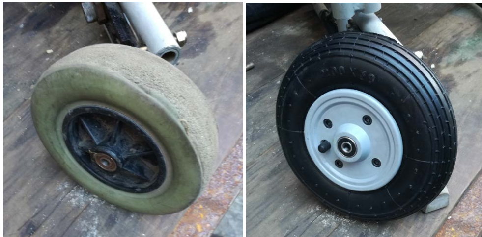
Figura 11. Ruedas delanteras desgastadas y su reemplazo. Fuente: elaboración propia
