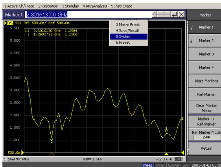
Figura 10. Relación de onda estacionarias de la antena fractal impresa.
