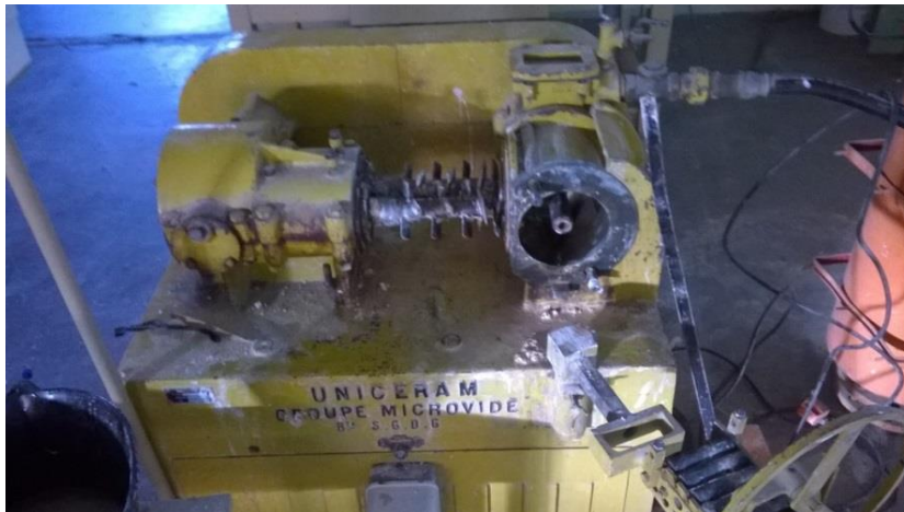
Figura 17: Extrusora (abierta para observación de sus partes) utilizada para el conformado de las agujas cerámicas.
