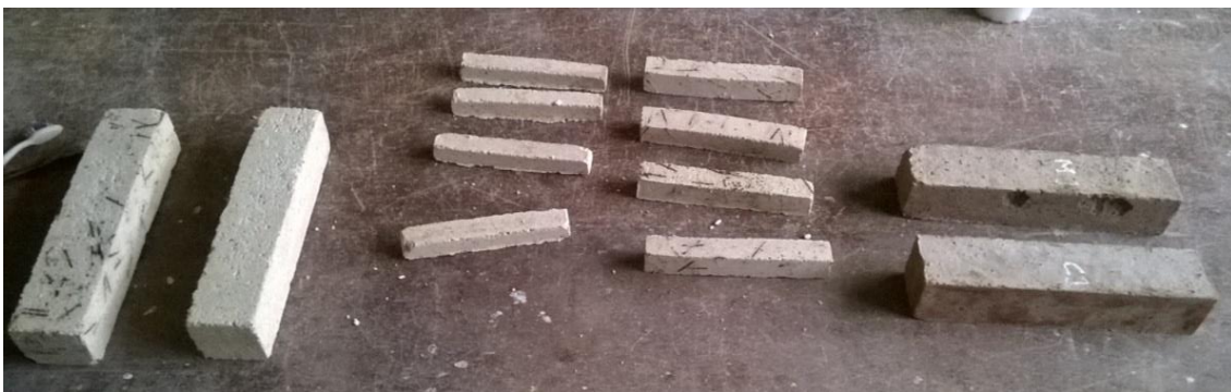
Figura 20: Barras de hormigón reforzadas con agujas metálicas y cerámicas.
