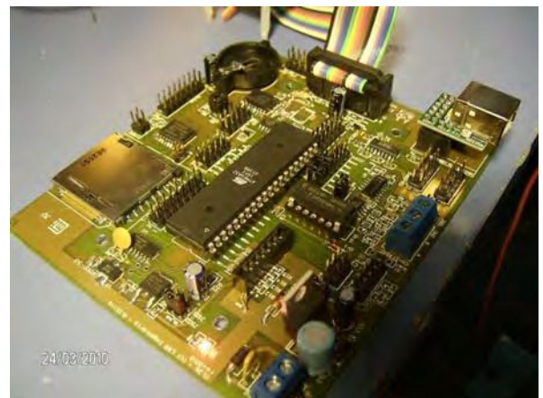
Figura 8. Placa CL2b-m1 con procesador AVR
