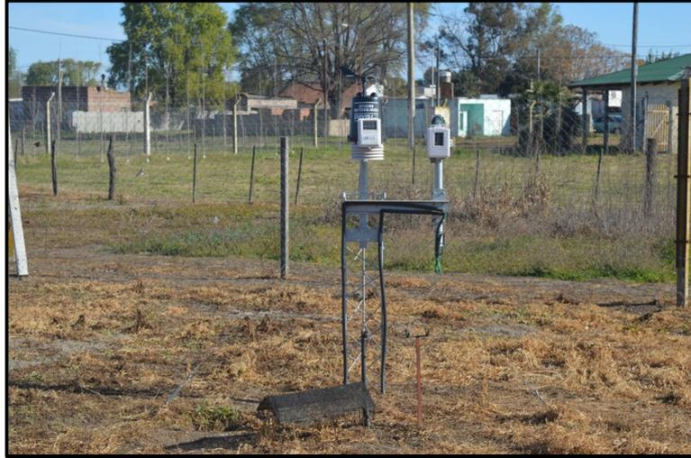
Foto 4-8: Instalación de la nueva Estación Meteorológica (con pluviógrafo)
