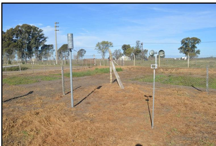
*Foto 4-7: Vista de pluviómetro y anemómetro*
