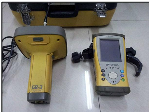
Foto 4-12: Equipo ToCom GR3. Antena y Receptor de Datos
