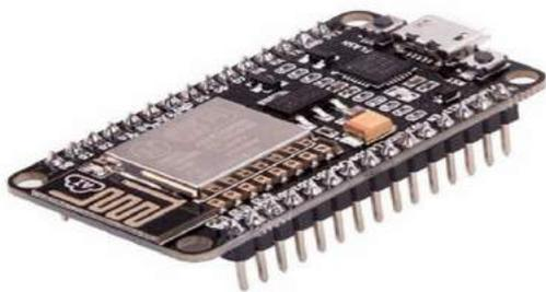
Figura 2. NodeMCU ESP8266.
