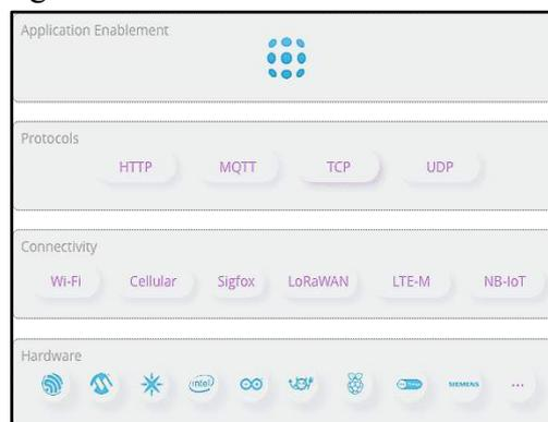
Figura 3. Stack de servicios de Ubidots
