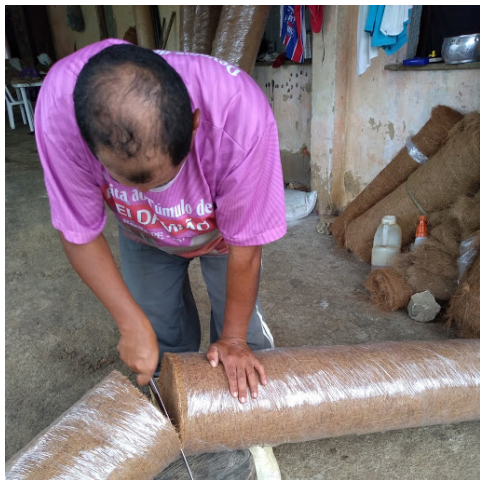
Figura 1. Corte da biomanta de fibra de coco em área de Agricultor no Povoado Alto dos Ventos. Areia Branca, SE, 2018.
