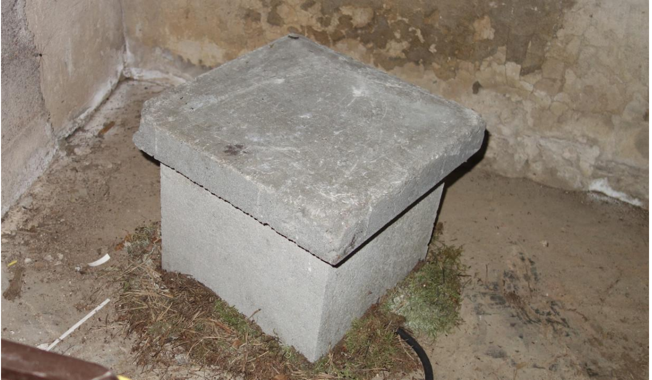
Kuva 3. Betonilaatta suojaa seismometriä VUOS-asemalla.
