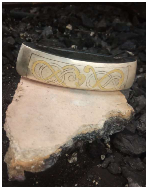
Kuldamalgaami lisamine. Kullatud muster pärast kuumutamist. Foto Edvards Puciriuss.
