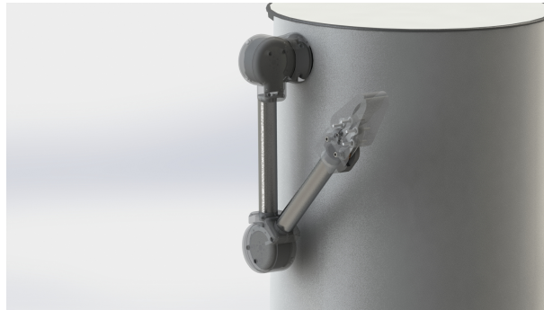
Joonis 4.4. Oskar III käte 3D mudel programmis SolidWorks. Foto ja disain: Marko Pirbe
