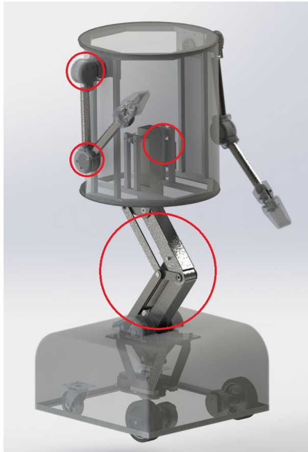
Joonis 4.5. Oskar III suured liigendid (tähistatud punaselt). Foto ja disain: Marko Pirbe
