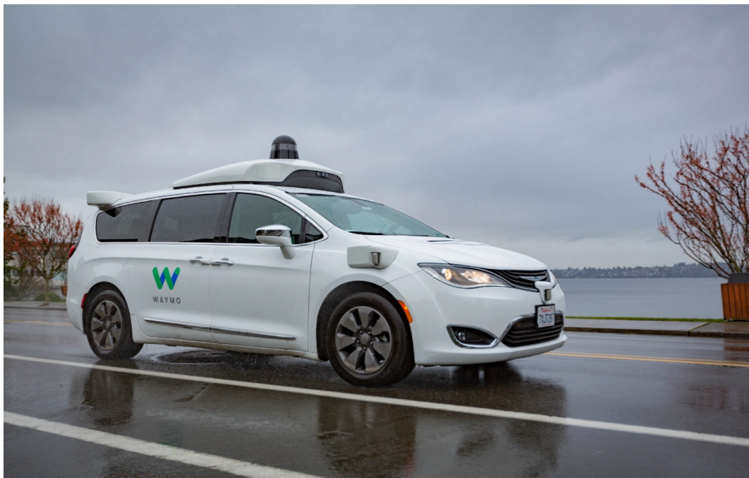
Figure 2.4: Waymo AV with the exterior sensors [4]
