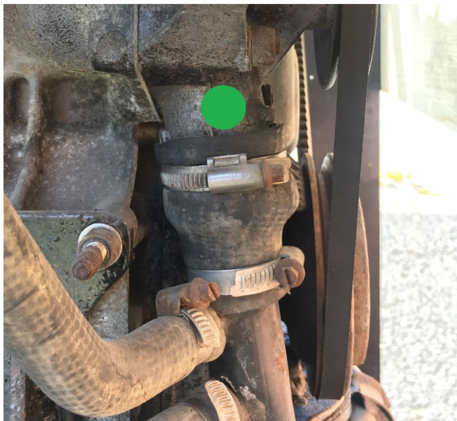
Obrázek 8-6 – Místo měření teploty za chladičem [Autor]
