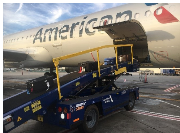
Obrázek 22: Pásový nakladač zavazadel s vlastním pohonem [33]
