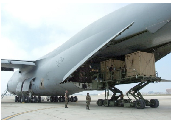
Obrázek 21: Nůžkový nakladač s jednou plošinou [30]
