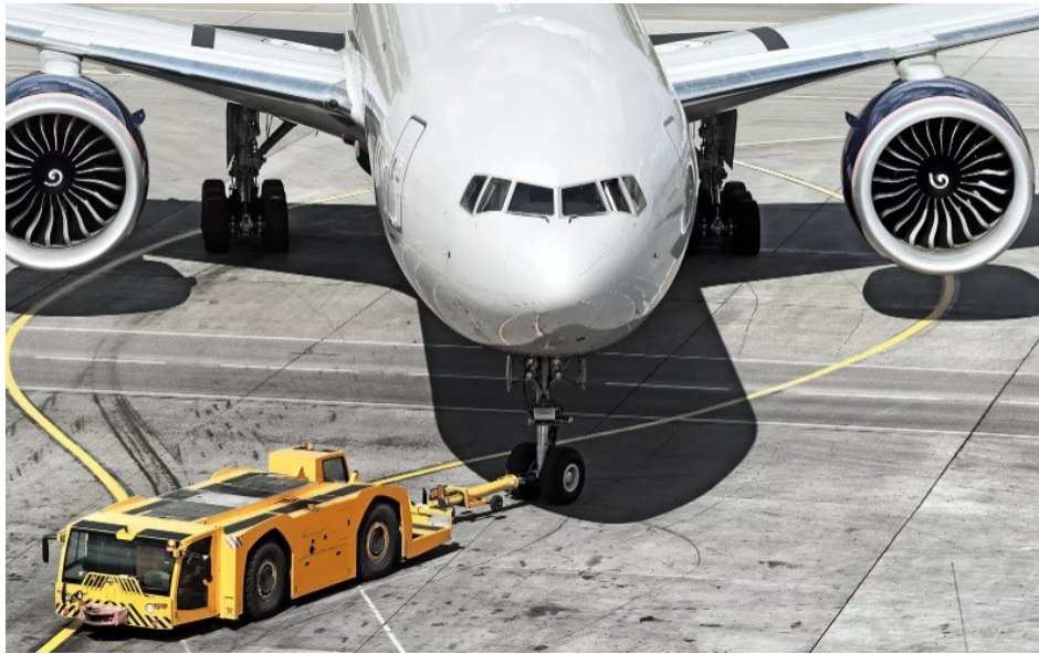
Obrázek 17: Tahač s tažným zařízením [27]
