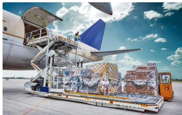
Obrázek 20: Nůžkový nakladač s oddělenými plošinami [31]
