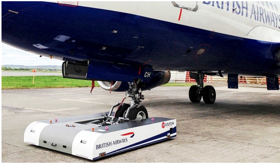
Obrázek 19: Dálkově ovládaný, elektrický TBL [29]
