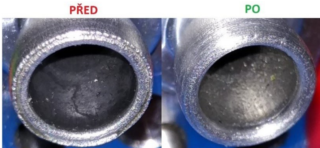
Obrázek 5.1 – Odjehlení trubky před a po zavedení moderní technologie.
