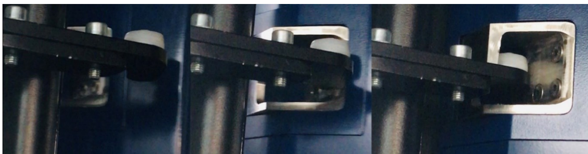
Obrázek 13 – Pohyb bočního naváděče při zasouvání
