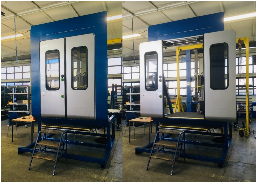
Obrázek 10 – Testování životnosti vlakových dveří
