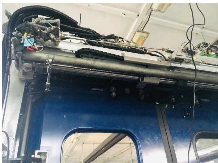
Obrázek 11 – Dveřní systém (pohled zevnitř vlaku)
