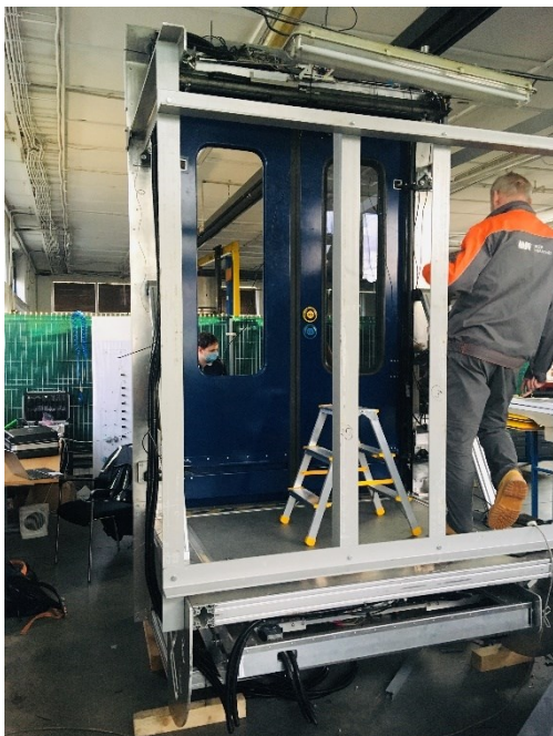
Obrázek 11 – Dveřní systém (pohled zevnitř vlaku)
